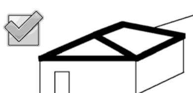
屋顶周边和边缘必须能抵抗更大的上抬荷载。要求加固连接。
