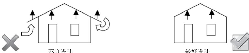
**W12. 尽量减小建筑物的总高度。**
