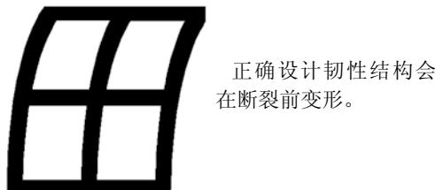
脆性材料、接头和整体结构不会消耗荷载能量，因此更容易断裂和倒塌。韧性材料的使用和韧性结构的设计要经过结构工程师的批准，这一点很重要。如果设计不当，韧性结构或结构构件可造成极其严重的结构损坏。甚至在荷载应力较大时韧性结构和材料也会发生断裂。
